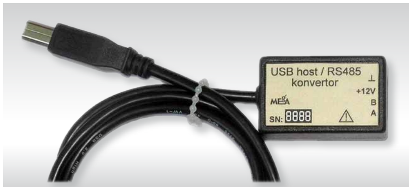
Obr. 1: Zobrazení konvertoru USBhost/RS485 v provedení pro MEg40 a MEg202.2
